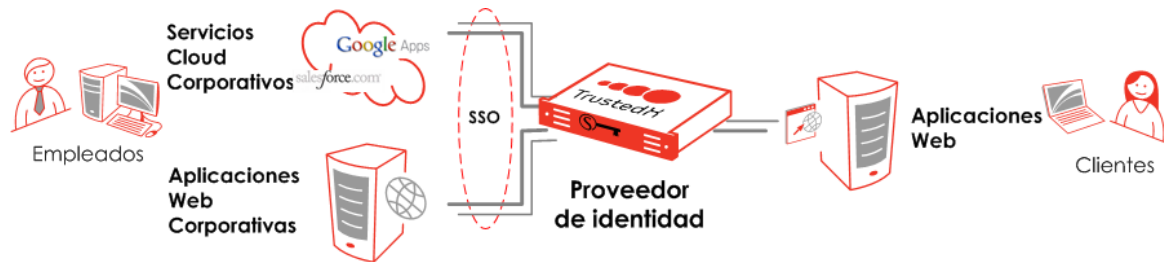
Figura 1-1. Casos de uso de TrustedX Autenticación PKI para workforce y protección de aplicaciones web orientadas a clientes.
